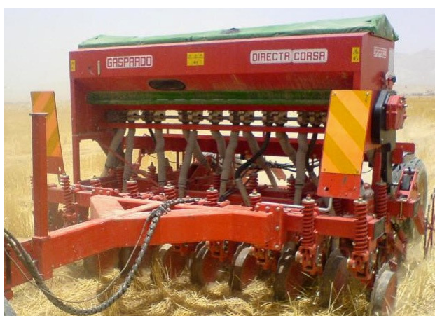
دستگاه کشت مستقیم با شیار بازکن دیسکی
